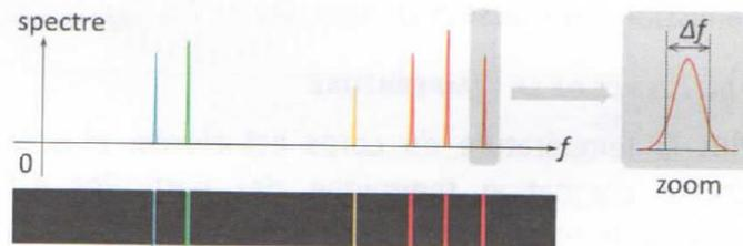
**Fig 10.** Le spectre d'une lampe à décharge est qualifié de discontinu parce que l'émission se produit seulement autour de fréquences bien précises. Les raies d'émissions possèdent cependant une largeur spectrale  $\Delta f$  qui dépend entre autres paramètres de la température.
